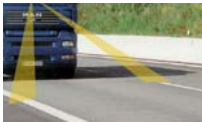
Система сохранения курса LGS: видеочамера записывает ход автомобиля по трассе
