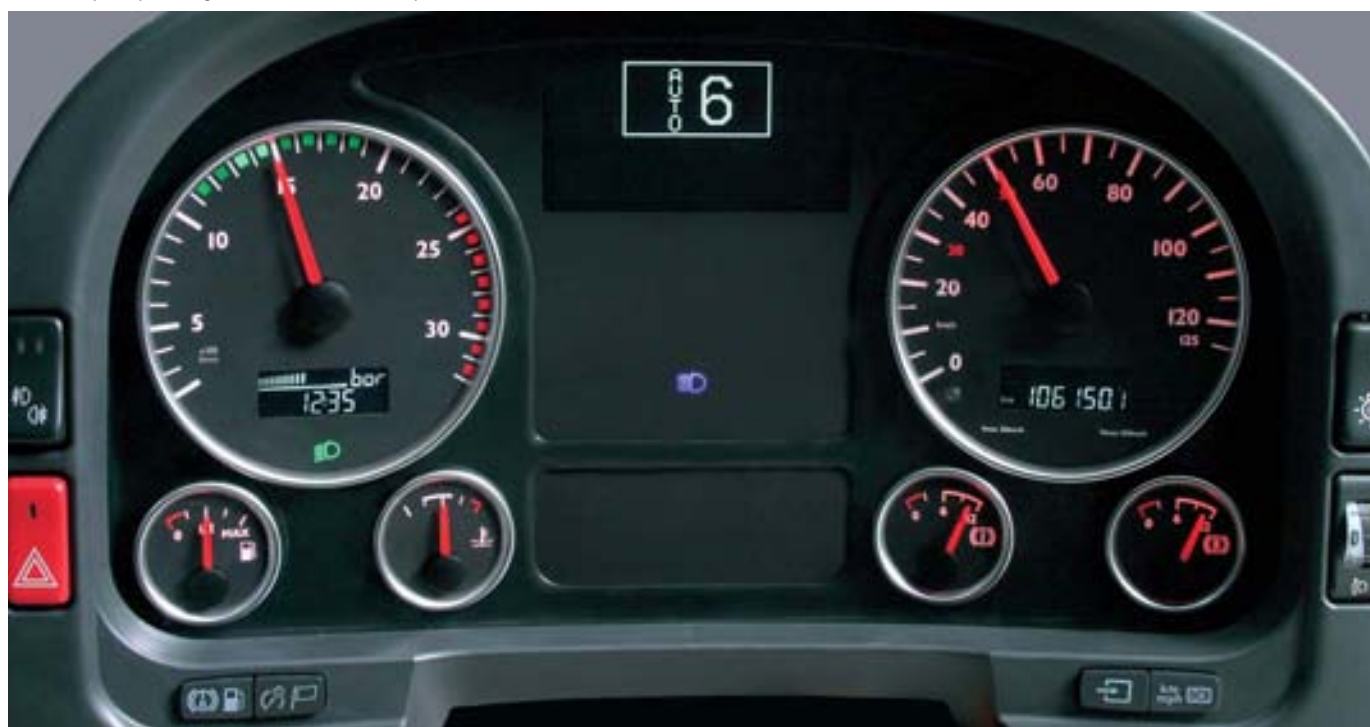
Панель приборов "Highline" с большим центральным дисплеем
