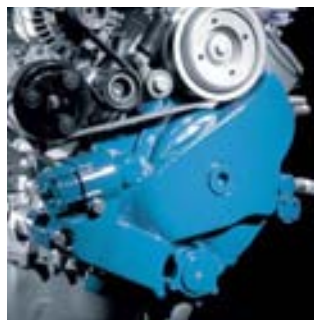
Первичный тормоз-замедлитель MAN на двигателе D28
