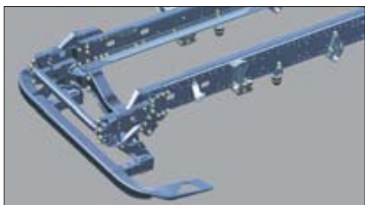
Передний край рамы и передний противоподкатный брус
