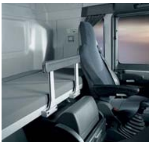
Спальное место в кабине водителя типа М для хорошего отдыха во время перерывов
