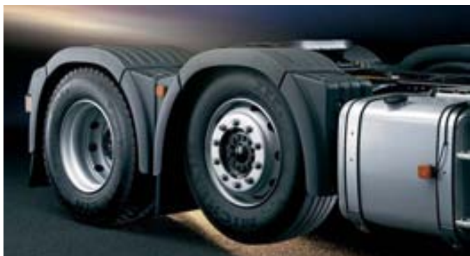
Поднимающаяся передняя ось задней тележки
