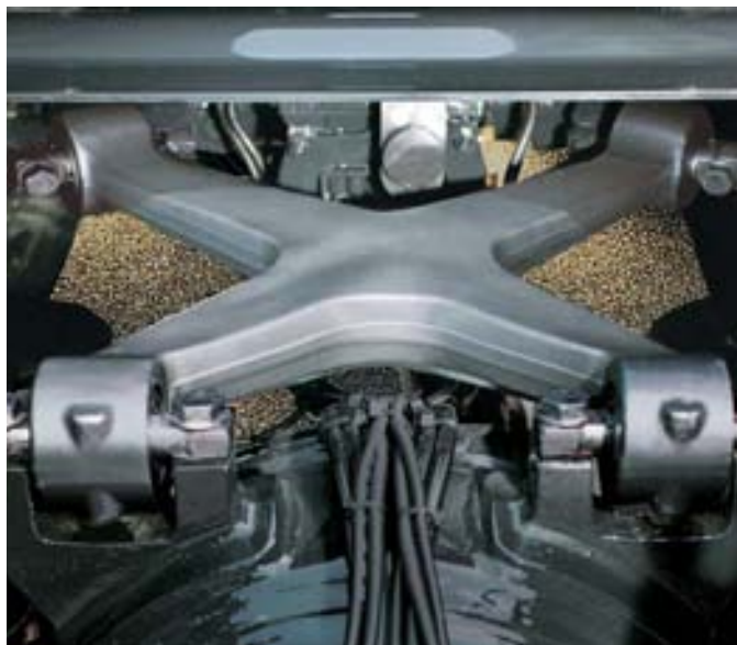
X-образный стабилизатор на задней оси
