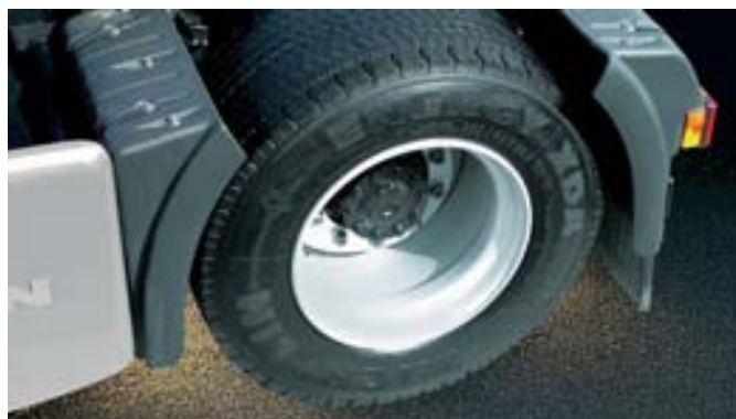
Сверхширокие шины размера 495/45 R 22,5 для уменьшения расхода топлива и увеличения полезной нагрузки, в сочетании с ESP и системой контроля давления в шинах (RDK)
