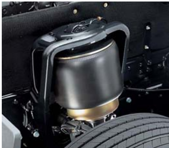
Пневматическая стабилизирующая система LDS на передней оси
