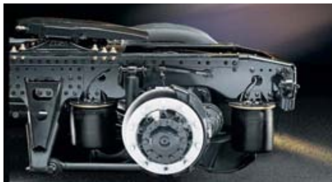
Втягивающаяся рама для очень низкой высоты прицепа
